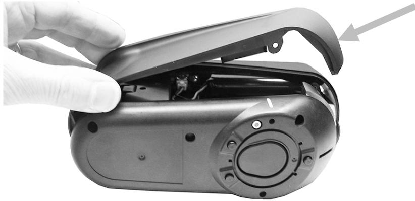
3. 배터리 커넥터 상단의 클립을 아래로 누릅니다. 배터리 커넥터를 천천히 바깥쪽으로 당겨 기존 배터리 팩을 제거합니다.
