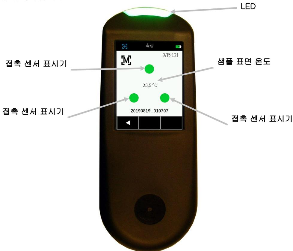
장치 전면에는 여러 색상의 LED 는 측정 및 접촉 센서의 상태에 관한 시각적 피드백을 제공합니다.
