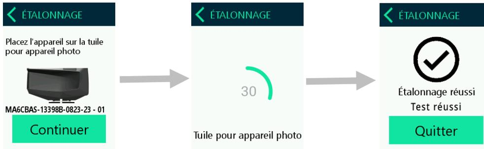
6. Retirez l'appareil une fois l'étalonnage terminé.
