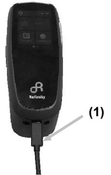
4. Ouvrez le capot de la station d'accueil. Insérez l'appareil dans la station d'accueil en orientant le connecteur USB-C vers le bas. Utilisez les deux tiges (2) comme guides. Faites passer le bracelet dans la rainure sous la station d'accueil.
