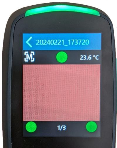
Exemple 1 : les capteurs de contact sont correctement activés et une mesure peut désormais être déclenchée.
