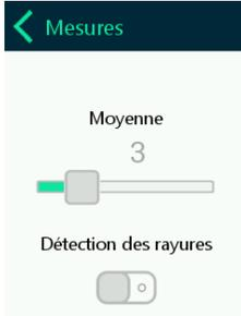
**Détection des rayures** : Si vous activez cette option, la détection des rayures met en évidence les rayures dans l'aperçu de la mesure. Repositionnez l'appareil sur un meilleur emplacement de mesure sans imperfections.
