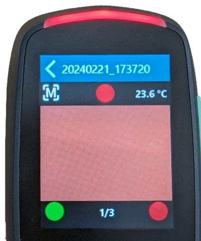
Exemple 2 : deux capteurs de contact ne sont pas activés et la mesure ne peut pas être déclenchée.
