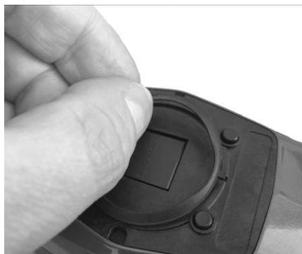
3. Appuyez sur le nouveau joint de façon à ce que les ergots en caoutchouc situés sous le joint soient tous correctement insérés. À ce stade, le joint doit reposer bien à plat sur l'instrument.
