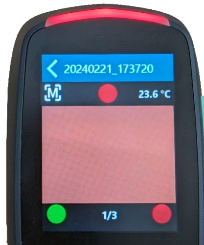
例 2：2つの接触センサーが接触されていません。測定を実行できません。
