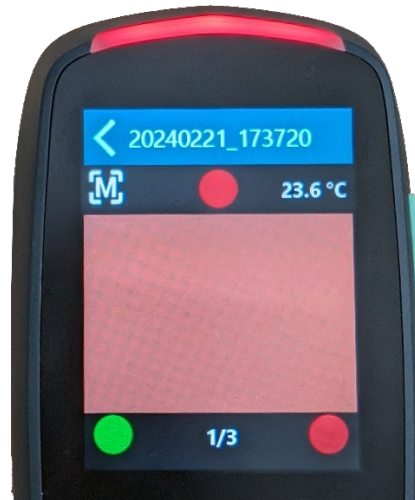
예제 2: 두 개의 접촉 센서가 적절히 접촉하지 않으면 측정을 시작할 수 없습니다.
