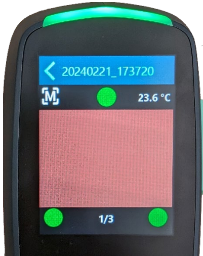
예제 1: 모든 접촉 센서가 적절히 접촉하고 있으면 측정을 시작할 수 있습니다.
