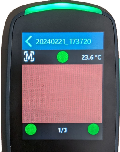
Exemplo 1: Todos os sensores estão em contato corretamente e uma medição pode ser acionada
