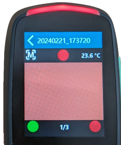
Exemplo 2: Dois sensores não estão em contato e a medição não pode ser acionada
