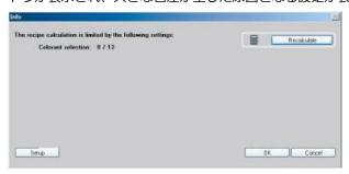
色相の差は、要求を緩和することで解消することも可能です。これを行うには、[**設定**] ボタンをクリック します。**配合値の設定**ウィンドウが開き、必要な変更を行います。[**情報**] ウィンドウに戻った後 [**再計算**] をクリックし、編集された設定で新しい配合を計算します。
